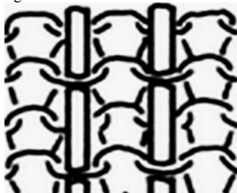
Figura 1.b Tricot plat cu fir de urzeală
