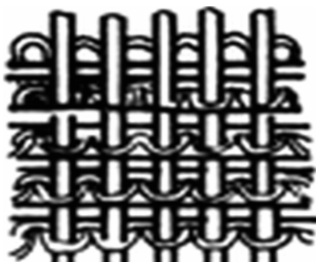
Figura 1.c. Tricot plat cu fir de batură și urzeală Figura 1.d. Tricot din urezeală cu fir de batură
