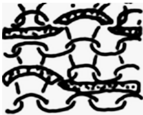
Figura 1.a Tricot plat cu fir de captușeală
